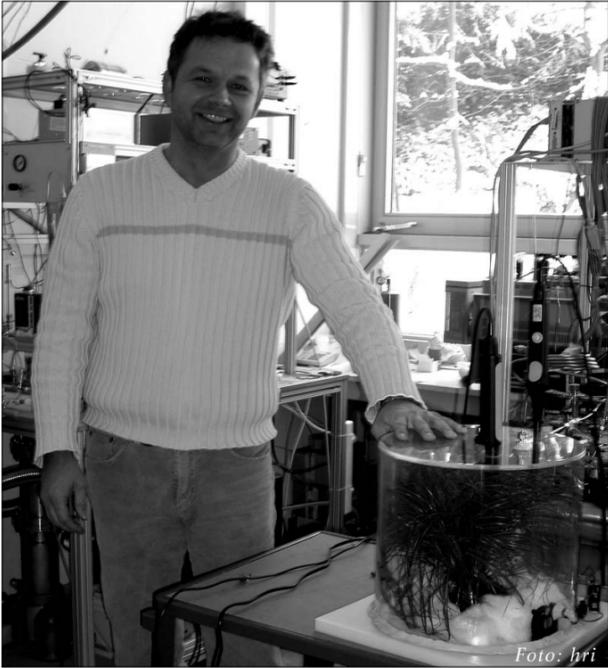
Dr. Frank Keppler im Labor. Rechts im Bild die Glasglocke, unter der die Spurengasemissionen der Pflanzen untersucht werden.
