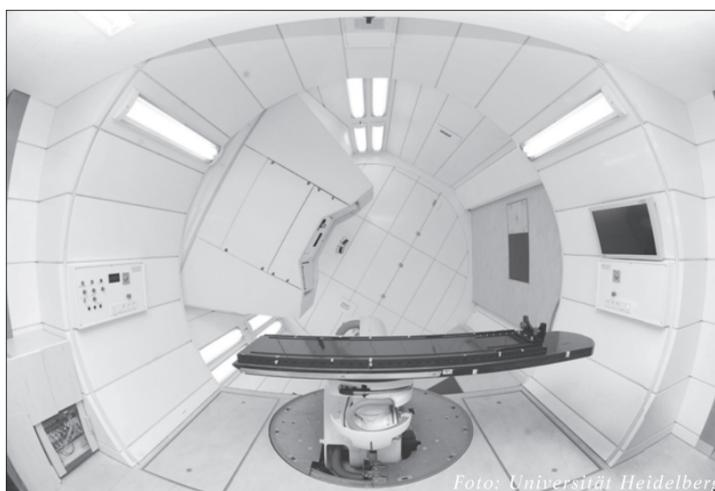
Das Innere der Strahlen-Gantry mit der drehbaren Wand.
